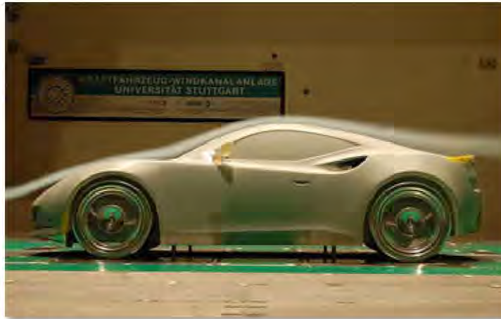
Figura 1.2.4 – Modello dinamico realizzato con parti mobili, impiegato per simulazioni in galleria del vento
