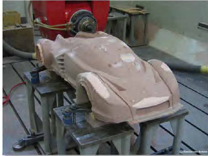
Figura 1.2.2 – Il modello in materiale sintetico viene ottenuto attraverso lavorazioni eseguite da macchine a controllo numerico
