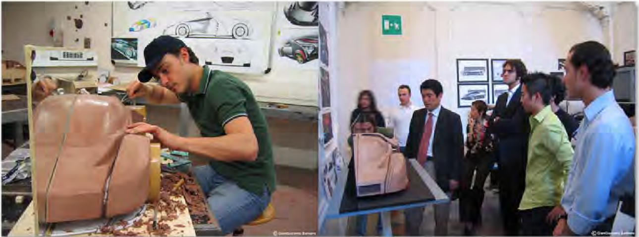
Figura 1.2.1 – Realizzazione a mano del modello in argilla e sua presentazione, per effettuare le prime valutazioni dal punto di vista del design
